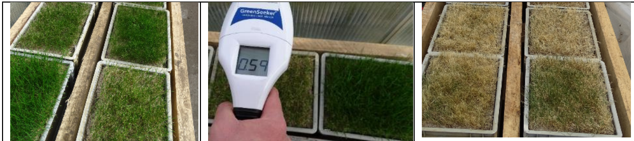
Abb.5: Gefäßversuche an der Hochschule Osnabrück zur Ermittlung der Trockenverträglichkeit durch NDVI-Messung bei unterschiedlichen Rasenmischungen. Fotos K.G. Müller-Beck
