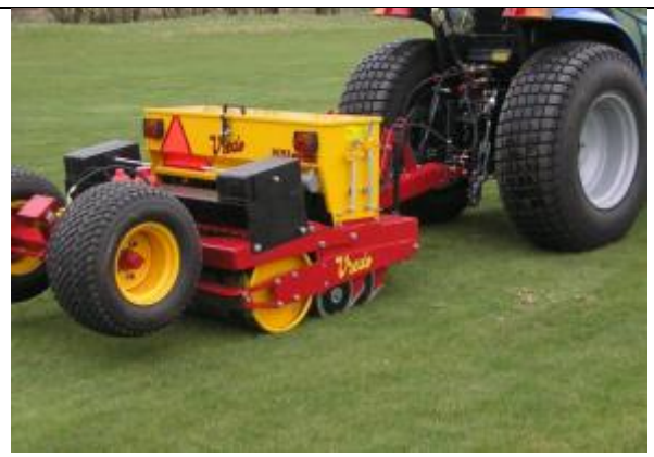
Abb.4: Doppereihiges Schlitzsaatgerät für die Rasennachsaat. Foto: K.G. Müller-Beck
