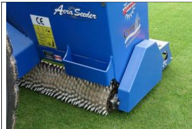
Abb.3: Spikeseeder für die flächige Nachsaat von Rasenflächen Foto: K.G. Müller-Beck
