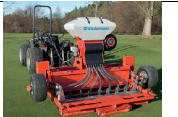
Abb. 6: Universalgerät „Terra Float Air“ zur Rasenregeneration mit pneumatischer Saattechnik. Foto: Wiedenmann
