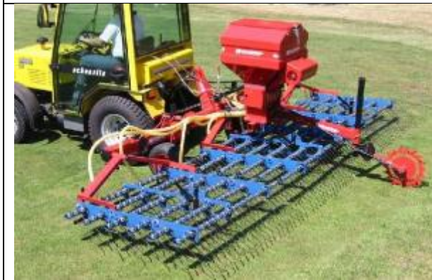
Abb.5: Rasenstriegel mit pneumatischer Saateinrichtung. Foto: Hatzenbichler
