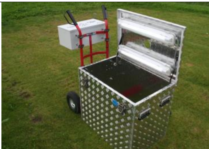
Abb.2: Geöffnete SigmaBox mit eingeschalteter LED-Beleuchtung (LAWSON, 2015).
