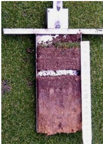
Abbildung 1: Pflegehorizont in Greenstragschicht durch Zunahme von organischer Substanz und Topdressmaterial mit Wirkung auf Verdichtungsneigung und Bildung von Porenbruch.
