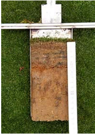
Abbildung 2: PflegehORIZONT in Greenstragschicht bei Veränderung der obersten Schicht durch Anreicherung von organischer Substanz mit negativer Wirkung auf Bodenluft und Bildung von Black Layer.
