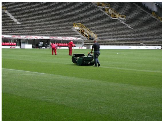
Abbildung: Stadionmäher mit Fangkorb bewirkt helle Streifen beim Blick in Fahrtrichtung (Foto K. Müller-Beck)
