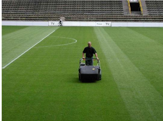
Abbildung: Stadionmäher im Einsatz; Rasen wirkt beim Blick gegen die Fahrtrichtung dunkel, in Fahrtrichtung erscheint er hell (Foto K. Müller-Beck)
