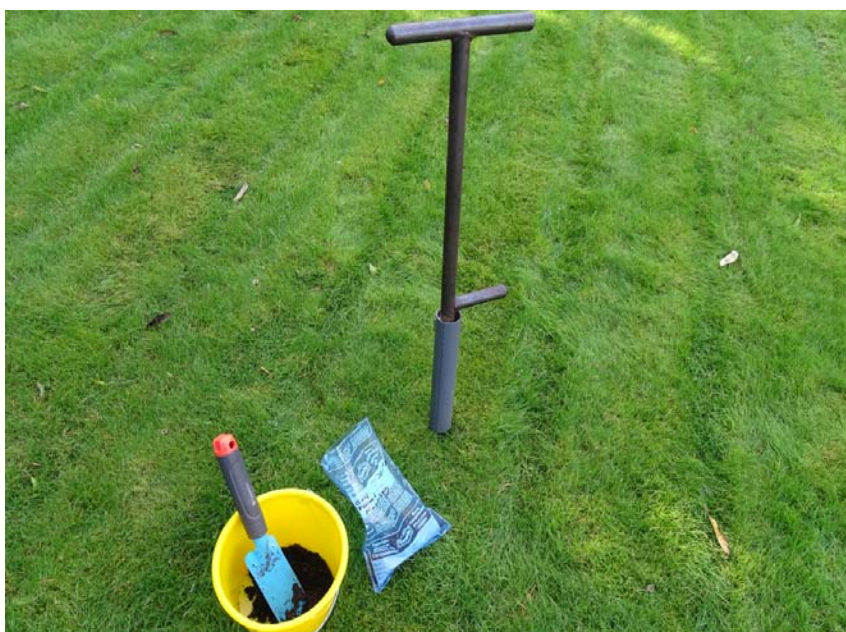
Abb.1: Erstellung einer Mischprobe aus 15-20 Einstichen und Abfüllung zum Versand von 300 bis 500 g Boden als Laborprobe. Ausrüstung Bohrstock mit Auskratzer, Sammeleimer und Versandbeutel. (Foto: K.G. Müller-Beck).
