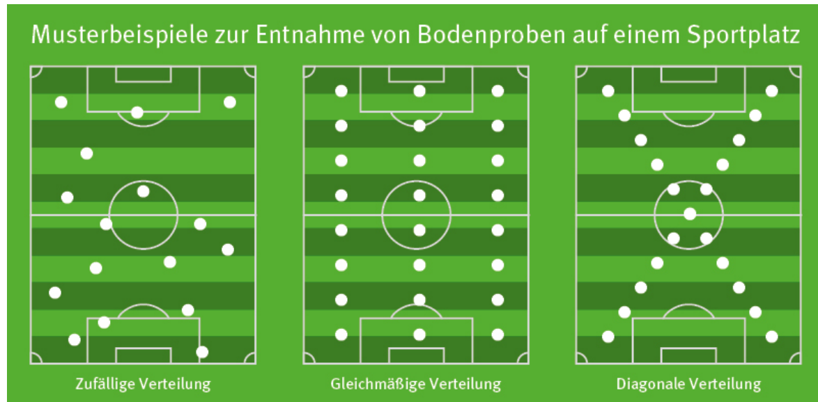
Abb. 2: Musterbeispiele zur Entnahme von Bodenproben auf einem Sportplatz. Zufällige Verteilung (li.); Gleichmaß (Mitte); Diagonale (re.) Quelle: K.G. Müller-Beck, 2020: Handout Greenkeeper-Fortbildung.
