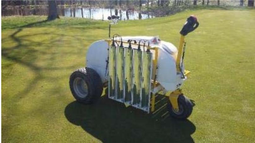
Abb. 1: UV-C Behandlungsgerät SGL UVC 180 zum Einsatz gegen Rasenkrankheiten (Foto: Prämaßing).
