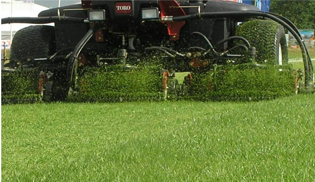
Abb.3: Einsatz eines Spindelmähers auf der Großfläche führt zu einem optimalen Schnittbild.
