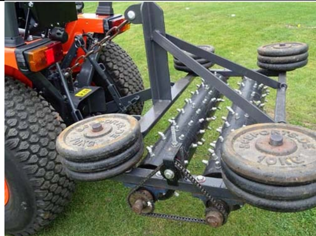
Abb. 1: Stollenwalze im Heckanbau am Rasentraktor zur Simulation von Belastungsintensitäten bei Rasenversuchen an der HS Osnabrück. Gewichtsbelastung und Schlupfwirkung der zweiten Rolle sind variabel einstellbar. (Foto: K.G. Müller-Beck)
