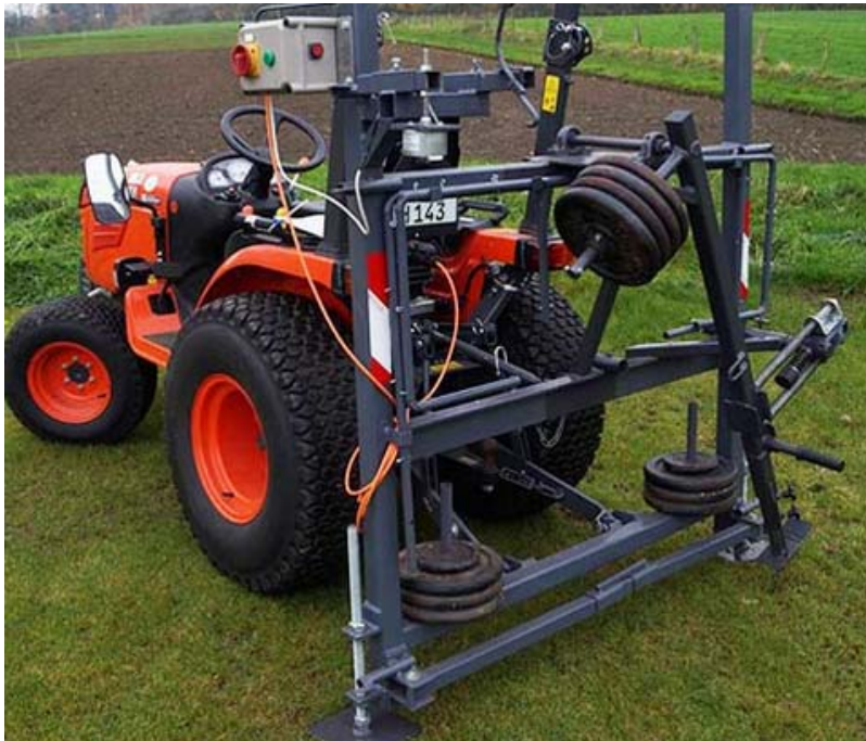
Abb. 10: Prototyp des mobilen Divot-Makers „Osnafoot“ in der Dreipunkthydraulik des Pflegeschleppers. (Foto: P. Lawson)
