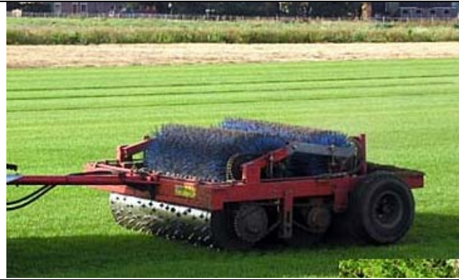
Abb. 3: Nutzung einer Doppel-Stollenwalze mit „Schlupf-Effekt“ im Rasenversuchsfeld des Züchters Barenbrug. (Foto: DRG, 2004)
