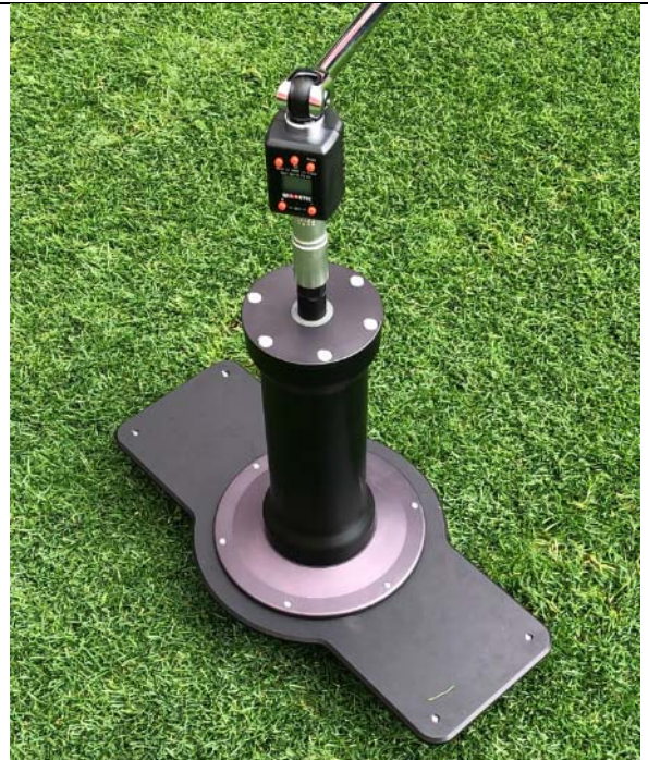
Abb. 7: Leichtes Stollenschergerät mit Drehmomentanzeige zur Messung des Drehwiderstandes der Rasennarbe. (Foto: H. Nonn)
