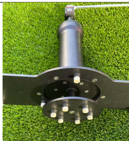
Abb. 8: Stollenschergerät zur Messung des Drehwiderstandes einer Rasennarbe in Newton Meter. (Foto: H. Nonn)
