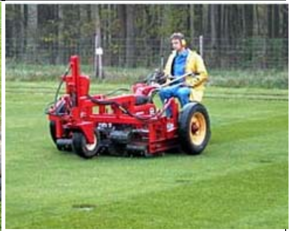
Abb. 2: Stollenwalze zur Simulation von Tritt- und Schereffekten in der Rasenanbauprüfung beim Bundessortenamt. (FREUDENSTEIN, 2006)
