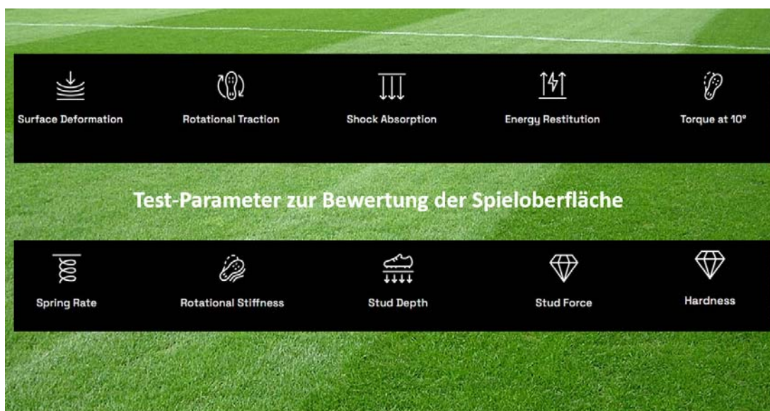
Abb. 12: Messparameter auf einer Rasenfläche zur Ermittlung des Grip-Test nach dem System RAW STADIA 2025. (Bearbeitung K. Müller-Beck)
