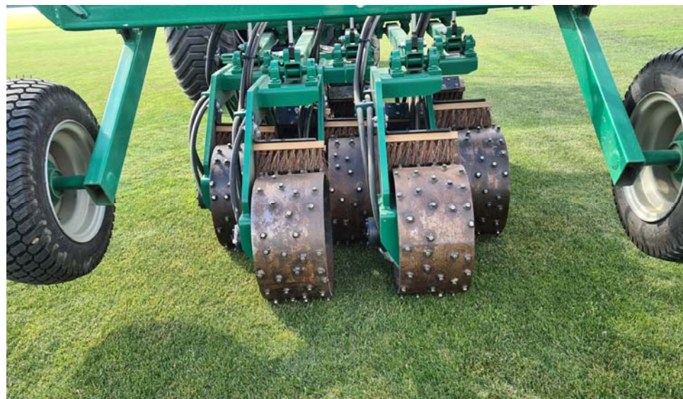
Abb. 5: Aufwendige Konstruktion einer Stollenwalze zur Simulation der Trittbelastung bei Rasengräsern. Hier auf dem Versuchsfeld des Gräserzüchters DFL in Dänemark. (Foto: K.G. Müller-Beck)
