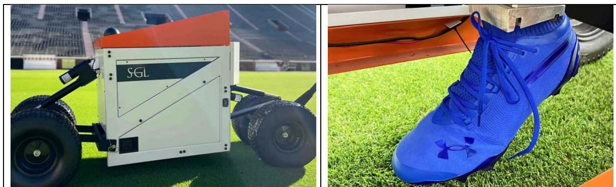
Abb. 14a +b: Neue Messvorrichtung fLEX zur Ermittlung der Spielfeldeigenschaften mittels eines geeigneten Fußballschuhs. (Quelle: SGL, 2025)
