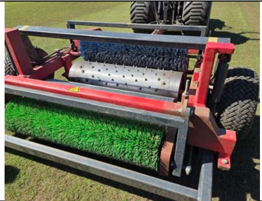
Abb. 4: Einsatz der Doppel-Stollenwalze zu Prüfung der Strapazierfähigkeit von Rasengräsern auf den Versuchsflächen des Züchters DSV in den Niederlanden. (Foto: K.G. Müller-Beck)
