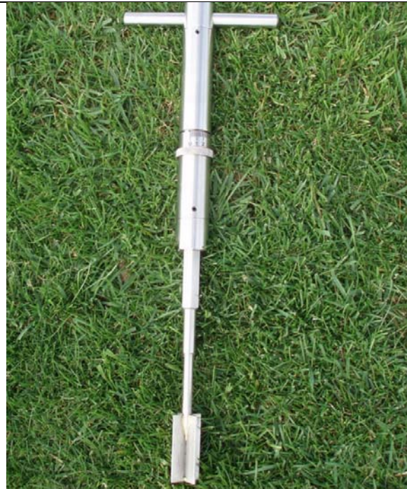
Abb. 6: GEONOR Flügelsonde mit Anzeigering zur Messung des Scherwiderstandes der Rasennarbe. (Foto: H. Nonn)
