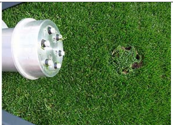
Abb. 9: Eingriff eines Stollenschergerätes in die Rasennarbe nach Messvorgang. (Foto: Müller-Beck)
