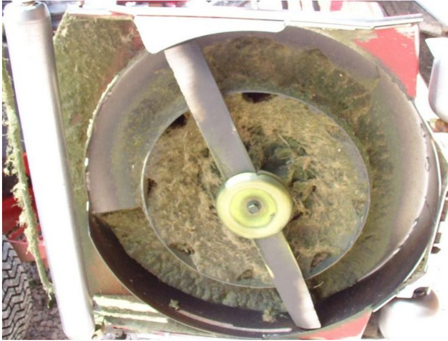
Abb. 2: Verklebungen von feuchtem Schnittgut im Deck des Sicheljähers führen zu Störungen beim Rasenschnitt.
