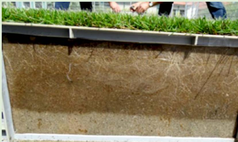
Rasengefäßversuch mit Erfassung des Wurzelbildes.
