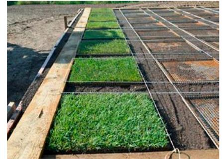
Foto 1: Versuchsanlage. Rechts im Bild die Lochblechkörbe zur Aufnahme der Fertiggrasstücke.
