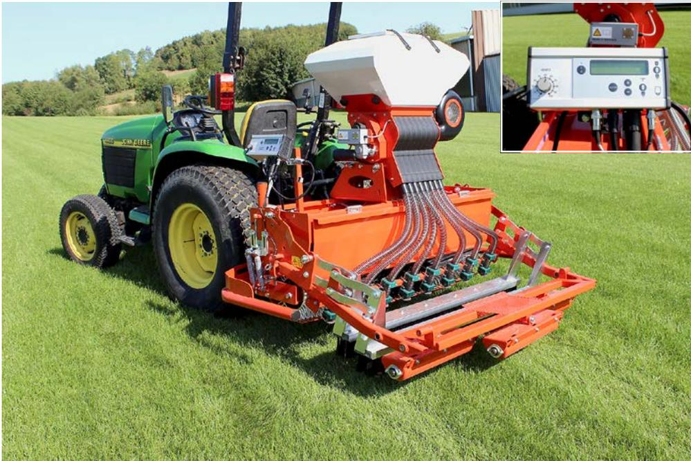
Die Terra Float Air ist ein produktives Arbeitsgerät mit mehreren Funktionen rund um die Rasensaart. Über den Bordcomputer (links am Terra Float Air angebracht) werden zentrale Funktionen wie Abdrehprobe, Restentleerung, Kalibrierung und Mengeneingabe gesteuert. (Alle Fotos: Wiedenmann)
