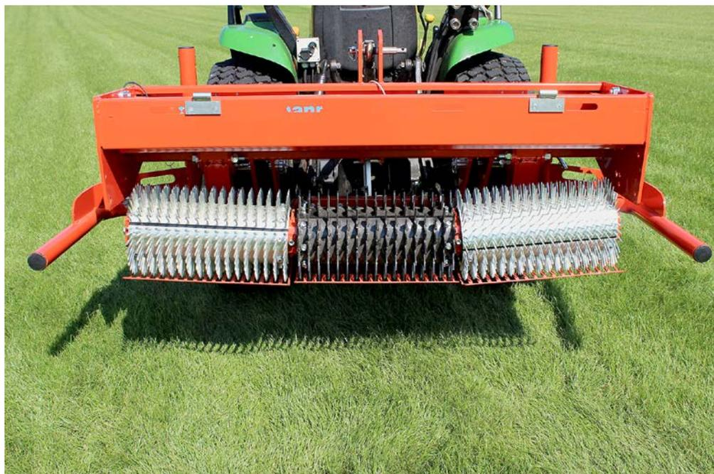
**Blick auf die freigelegte Walzeneinheit: Montiert sind hier verschiedene Zinkenstärken. Die sternförmigen Schlitzmesser in der Mitte schneiden schonend ohne Boden auszuwerfen.**
