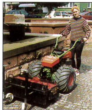
nach Verunkrautung und Pflaster können Zusatzgewichte montiert werden. Mit den Geräten kann in Vorwärts- und Rückwärtsfahrt gearbeitet werden.
