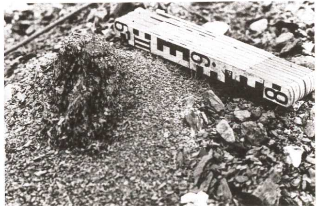
Abb. 2: Physikalische Verwitterung an der Haldenoberfläche.
