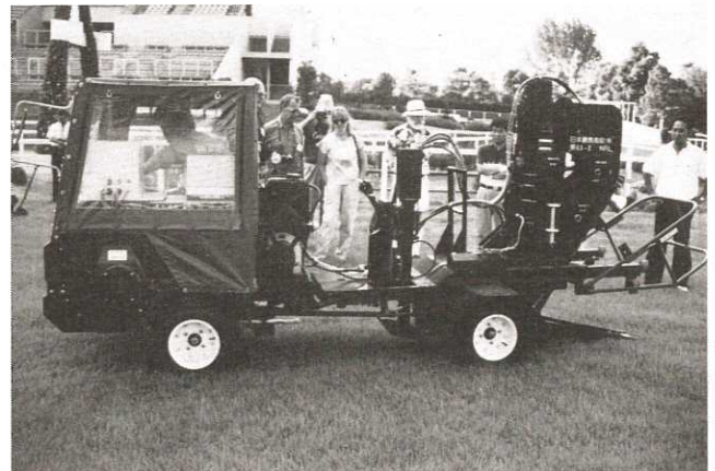
Abb. 2: Prüfapparatur zur Bestimmung der Belagshärte einer Pferderennbahn.
