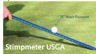
Stimpmeter-Werkzeug zur Ermittlung der Ballrollstrecke (Green Speed) auf dem Golfgrün. Entwicklung vom hölzernen Original zum aktuellen USGA-Werkzeug (blau), mit der Möglichkeit zur Nutzung einer verkürzten Messstrecke
