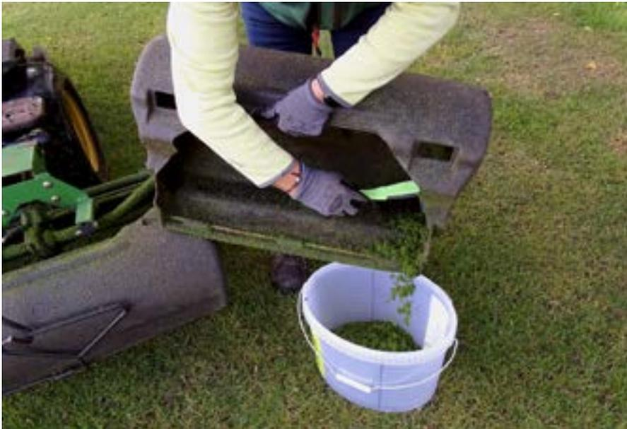
Abb. 3: Leerung der Fangkörbe in den Messbehälter (Skalierung in Liter) zur Ermittlung des Schnittgutvolumens je Grün. (Foto: K.G. Müller-Beck)
