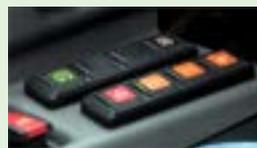
Mit dem elektronisch geregeltem Antrieb ecDrive von Weidemann können Arbeitsmaschinen bedarfsgerecht gefahren werden. Er hat vier Modi. Beim Anbaugeräte-Modus wird bei steigender Belastung (z.B. viel Material vor dem Mulcher oder der Schneefräse) automatisch die Fahrgeschwindigkeit zurückgenommen.
